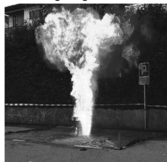
Löschversuch eines Fettbrandes durch Wasser
