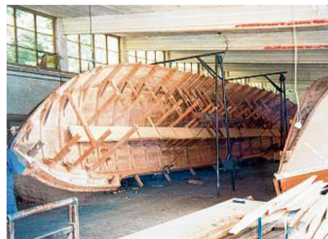
Damit der Rumpf durch das Tor der Werfthalle passte, wurde er in zwei Hälften zerlegt.
